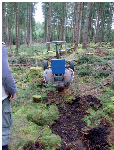
3 Rillensaat für Eiche mit Fräse (li) Anlage von Saatrillen für Weißtanne mit Scheibenegge (re.) Foto: W. Rothkegel Foto: O. Ruppert
