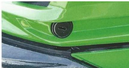
Zukünftig sollte man immer das passende Werkzeug zum Öffnen der Motorhaube bereithalten. Werkzeuglos ist dies nicht mehr zulassungskonform.
