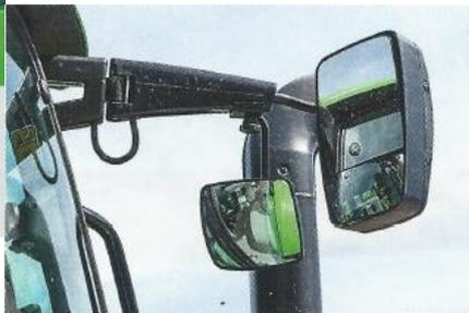
Auch Weitwinkelspiegel müssen an alle neuen Schlepper angebaut sein. Dies verbessert die Sicht nach hinten und somit die Sicherheit im Straßenverkehr deutlich.
