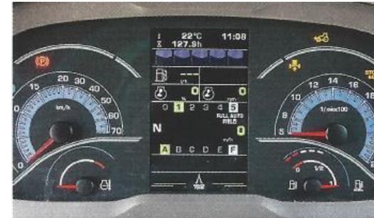
Um die Bestimmungen der Tractor-Mother-Regulation zu erfüllen, wird eine Voreilung der Tachometer, wie bei allen Pkw, zur Pflicht.
