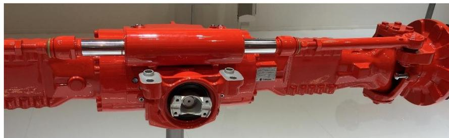
Gleichlauflenkzylinder mit integrierter Spurstange
