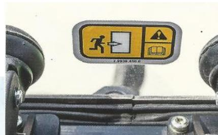
„Im Notfall bitte aus der Heckscheibe klettern“, sagt dieser Notausgangs-Aufkleber aus, der in Zukunft auf allen neuen Traktoren zu finden ist.
