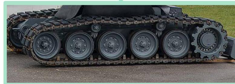
**Flexibles Softlaufwerk mit Hartgummibesatz**
