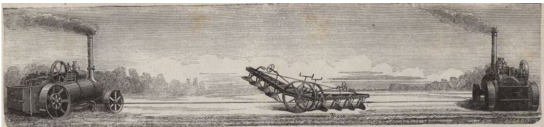
Abbildung 1 Lokomobile beim Pflügen mittels Seilwinden (Karl Eduard, 2015)
