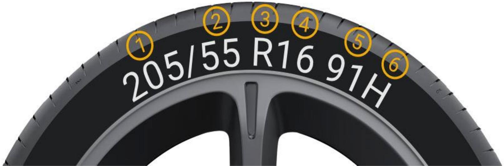
1. Reifenbreite in Millimeter
