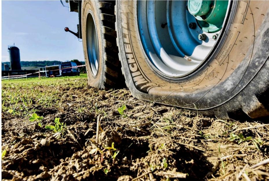
→ Für alle Arbeiten die mit niedrigem Reifendruck gefahren werden sollen, sind Radialreifen besser geeignet
