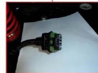
Zur Steuerung der dritten oder vierten Funktion am Frontlader liegt ein Stecker hinter dem linken Aufstieg, wo die Signale von F3 und F4 anliegen. Diese Signale können Relais ansteuern, doch nicht direkt Magnetventile!
