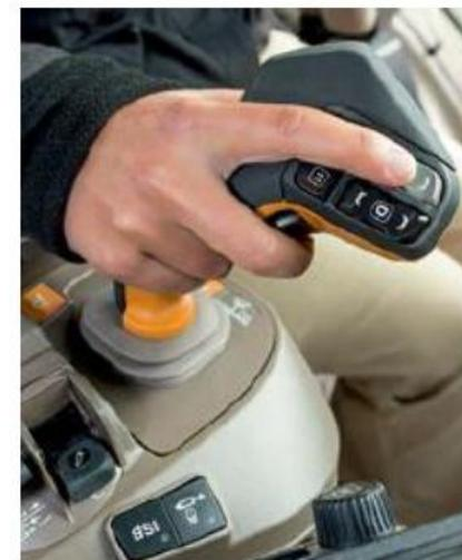
Der Wendeschalthebel links kehrt immer in die Mittelstellung zurück, da man auch mit dem Hebel rechts (bei gedrückter Aktivierungstaste) die Fahrrichtung wählen kann.
