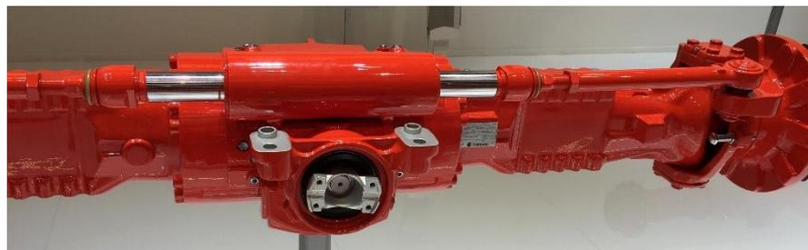
Gleichlauflenkzylinder mit integrierter Spurstange
