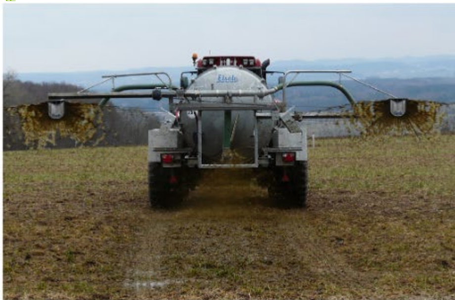
Foto 4: Duplexverteiler (ab 2025 nicht mehr zulässig)
