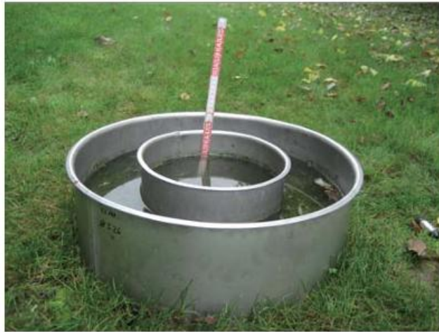
Abbildung 1: schematischer Aufbau des Doppelringinfiltrometers nach Durner (2003)
