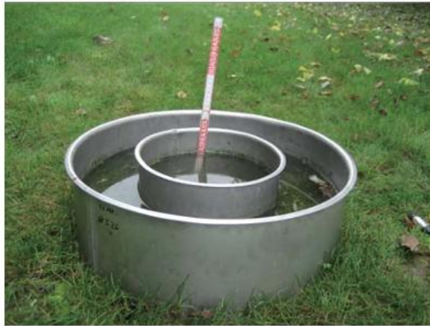
Abbildung 1: schematischer Aufbau des Doppelringinfiltrometers nach Durner (2003)
