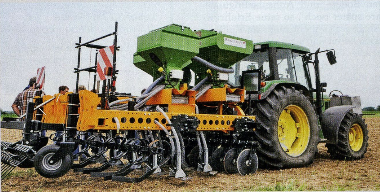
Das Weco-Dyn-System lässt sich neben dem Tiefenlockerer mit acht verschiedenen Werkzeugen ausrüsten.
