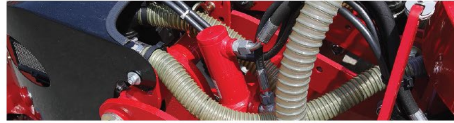
Hydraulikzylinder zur Schardruckerzeugung
