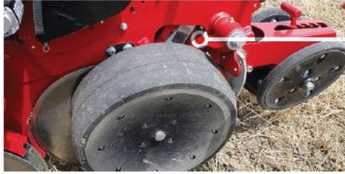
Maissägregat mit Piezo Messtechnik
