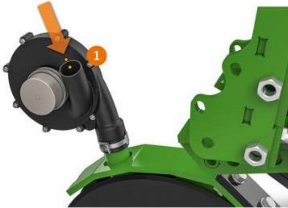
Systemaufbau FertiSpot – Rückseite Dosiereinheit
