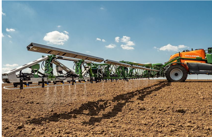
Spritzgestänge mit Kamerasystem zur Unkrautererkennung
