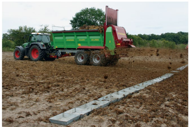
Bild 2: Mobiler Prüfstand zur Ermittlung der Querverteilung
