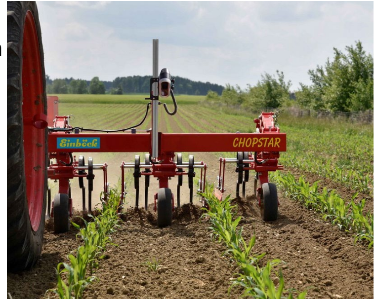
Beikrautregulierung in Mais mit kamerageführter Hacke
