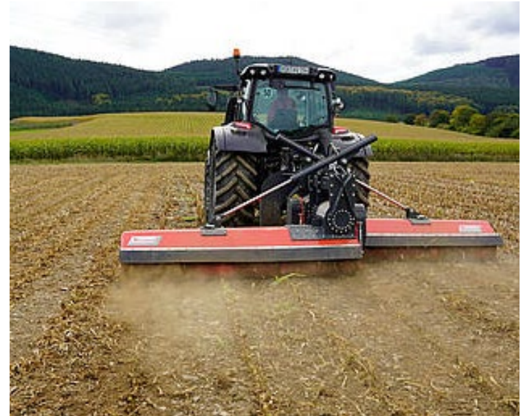
Mulchen von Maisstoppeln zur Zünslerbekämpfung
