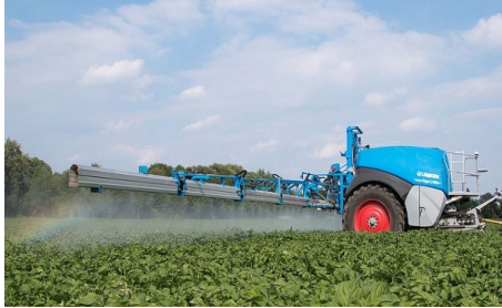
Lemken: Düsenstock in Aluminium Rahmen verbaut
