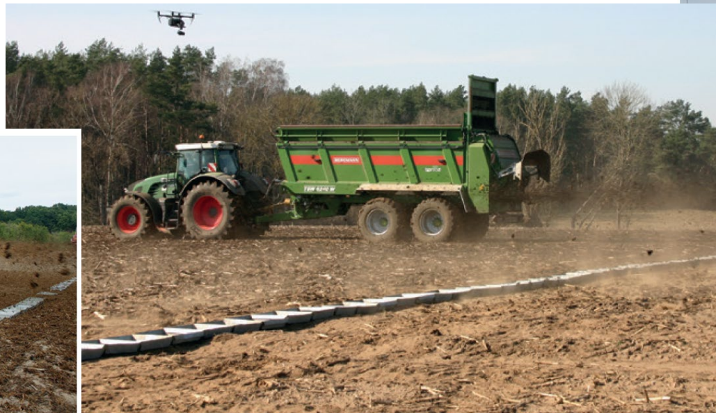
Bild 2: Prüfstand zur Ermittlung der (Lehrbuch) Querverteilung
