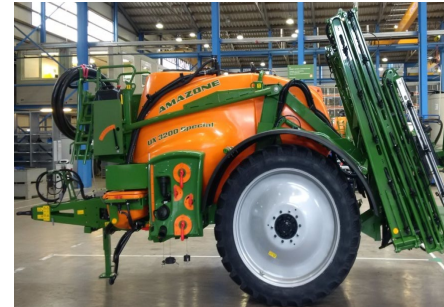
Amazone: Packetklappung mit Parallelogrammaufhängung
