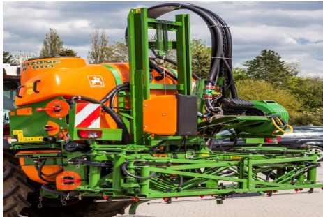
Amazone: Gestänge an Hubmasten angebaut
