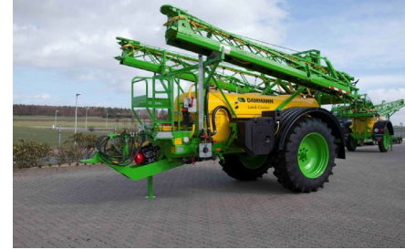
Dammann: Z-Klappung mit Parallelogrammaufhängung
