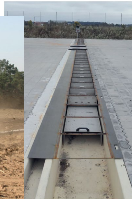
Bild 2: Prüfstand zur Ermittlung der (Lehrbuch) Querverteilung
