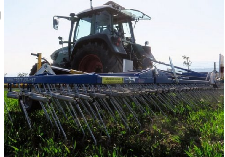
Beikrautregulierung im Getreide mit Striegel
