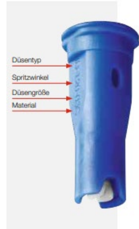
Flachstrahldüse ID-120-03C
