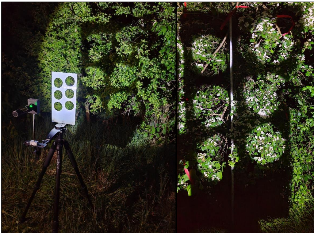
Abbildung 2: Versuchsaufbau mit der Blende (links). Lichtflecken der Blende auf einem Weißdorn (rechts; Quelle: eigene Aufnahmen).
