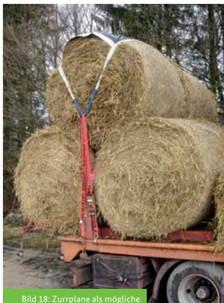
Bild 18: Zurrplane als mögliche Sicherung von Strohballen
