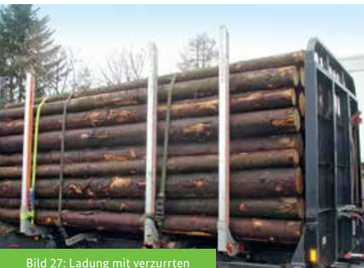
Bild 27: Ladung mit verzurrten Baumstämmen zwischen Runen
