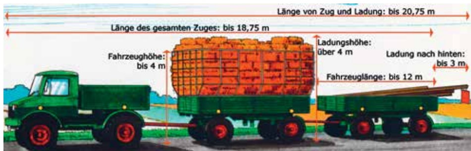
Abbildung 2: Fahrzeug- und Ladungsabmessungen mit lof Erzeugnissen
