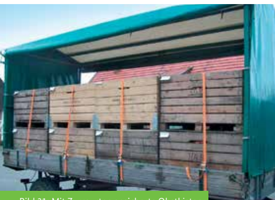
Bild 31: Mit Zurrgurten gesicherte Obstkisten
