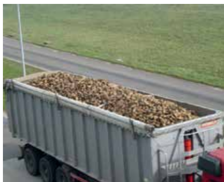
Bild 10: Bei Schüttgütern besteht allseits Formschluss, außer im Bereich des Ladekegels.
