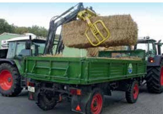
Bild 9: Die erste Lage Strohhallen liegt formschlüssig im Anhänger; werden weitere Ballen darauf geladen, so ist für diese eine Sicherung mit Zurrgurten erforderlich.
