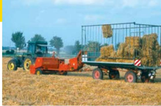
*Bild 32: Anhänger mit Ladegatter für kleine Strohballen*
