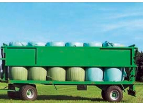
*Bild 37: Spezialanhänger u. a. für den Transport von Silageballen*
