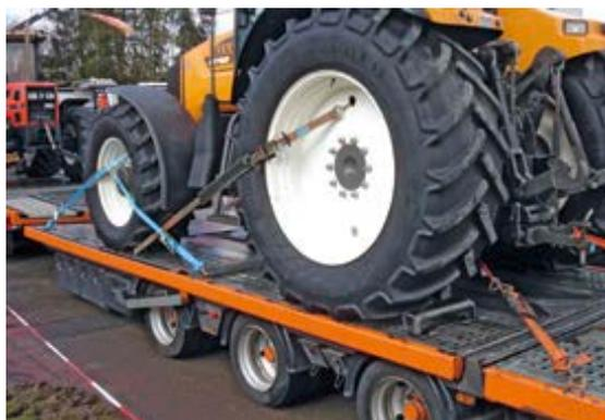
*Bild 39: Direkt-verzurrter Traktor*
