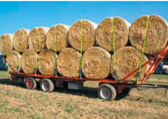
*Foto 36: Mit Zurrgurten gesicherte Rundballen auf einem Spezialanhänger*
