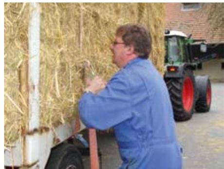
Bild 19: Überprüfen der Zurrgurte vor Verlassen der Ladestelle
