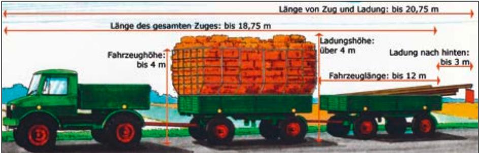
Abbildung 2: Fahrzeug- und Ladungsabmessungen mit Ilof-Erzeugnissen
