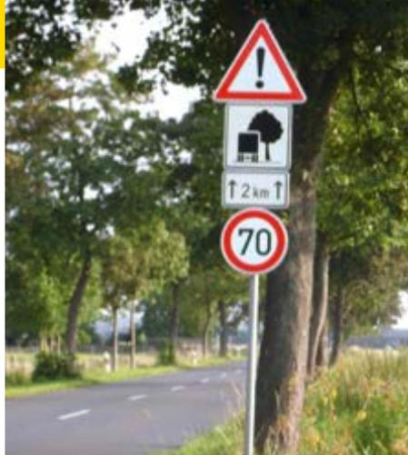
Bild 2: Beim Befahren von Alleen die Höhe der Ladung beachten („Lichttraumprofil“)
