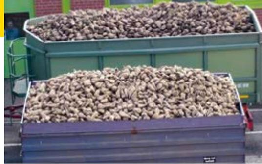
Bild 24: Anhänger mit Rüben: vorderer Anhänger zu hoch beladen, hinterer Anhänger o.k.
