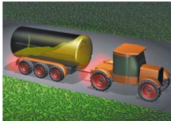
Abbildung 12: Schwallen des Tankinhaltes beim Bremsen
