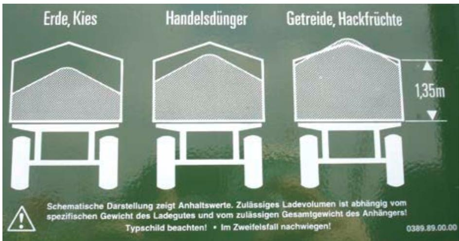
Bild 43: Ladungshöhen durch unterschiedliche Güter
