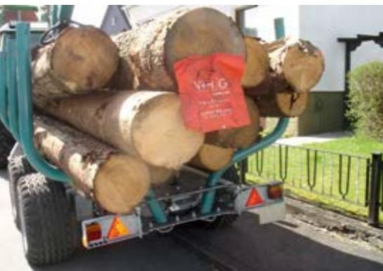
Bild 27a: Rückwärtige Kenntlichmachung eines Rückewagens. Die Baumstämmen sind zusätzlich mit Zurrgurten gesichert.
