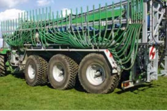
*Bild 30: Gülleschläuche in Transportstellung:
