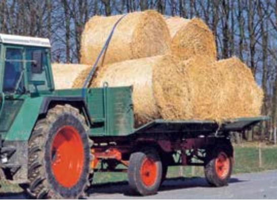
*Bild 35: Kombinierte Ladungssicherung bei Strohballen durch Fahrzeugaufbau (schräg gestellte Bordwände) und Zurrgurt*
