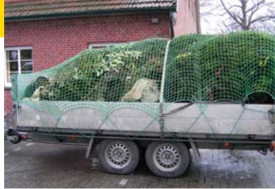
Bild 28: Sicherung von Ästen durch Netz und Zurrgurt
