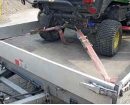
*Bild 11: Maschinen und Geräte werden meistens direkt (diagonal) verzurrt.*
