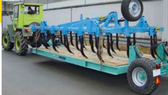
*Bild 38: Ausreichend gesichertes Arbeitsgerät (Fahrversuche); durch das Direktzurren setzen sich die Grubberzinken im Holzboden fest.*
