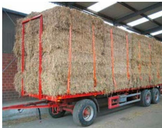
Bild 22: Sicherung durch Stahlrunge und Zurrgurte
