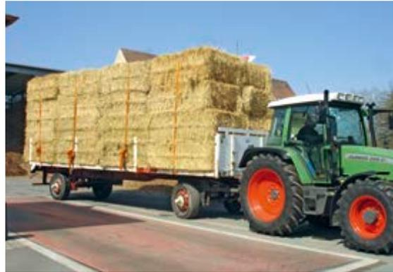
*Bild 33: Die niedrige Stirnwand und die nicht ausreichenden seitlichen Rungen machen eine Sicherung durch Zurrgurte erforderlich. Durch die Zurrgurte werden die Ballen gut miteinander verbunden.*
