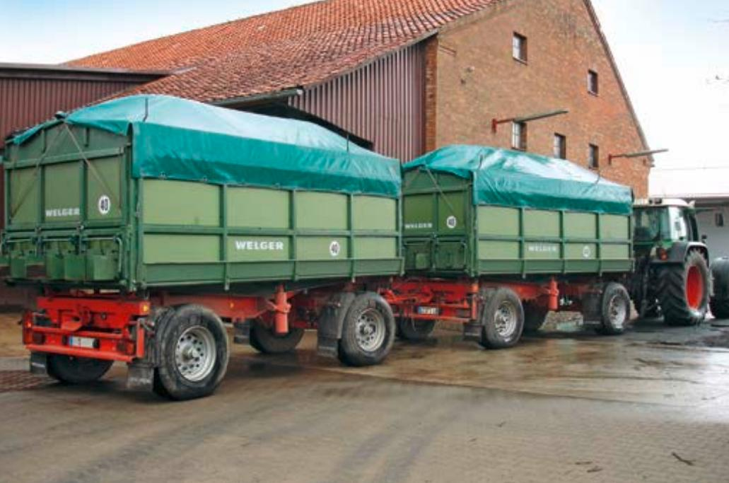
*Bild 21: Anhänger mit überhöhter Ladung unter straff gespannter Abdeckplane*
