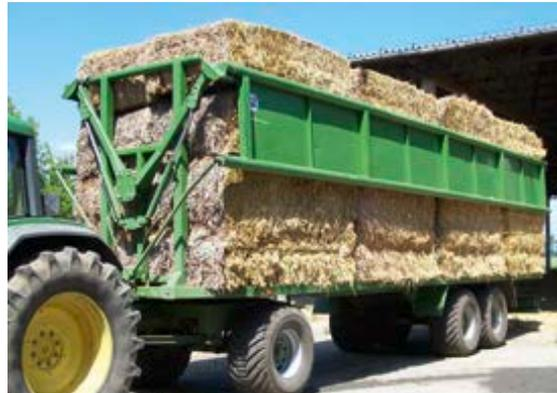
*Bild 34: Spezieller Strohtransportwagen*
