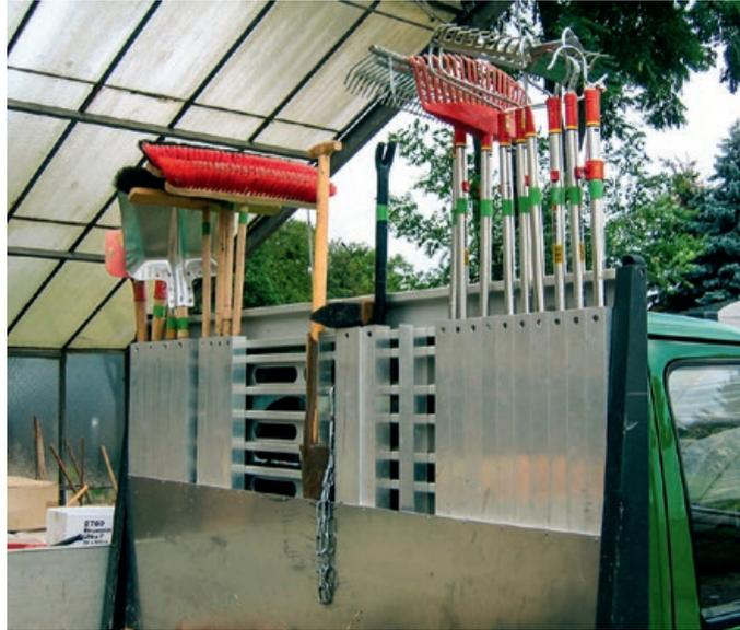
Formschlüssige Sicherung von Gartengeräten an der Stirnwand des Fahrzeugs und Lagerung von Werkzeugen und Kleinmaschinen in mit Ladefläche fest verbundener Transportkiste ▶
