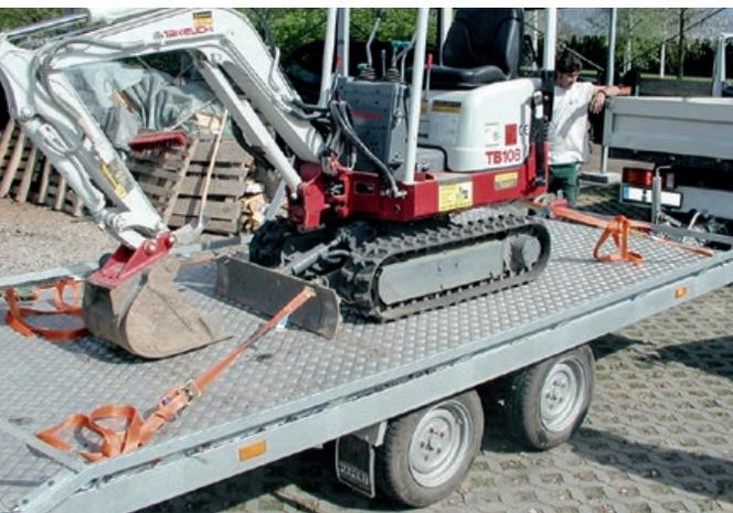
◀ Diagonalzurrn eines Minibaggers mit Schwerlastzurrgurten
