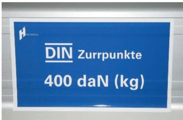
*Kennzeichnung eines Zurrpunktes für ein Fahrzeug mit einer zulässigen Gesamtmasse von 3,5 t.*
