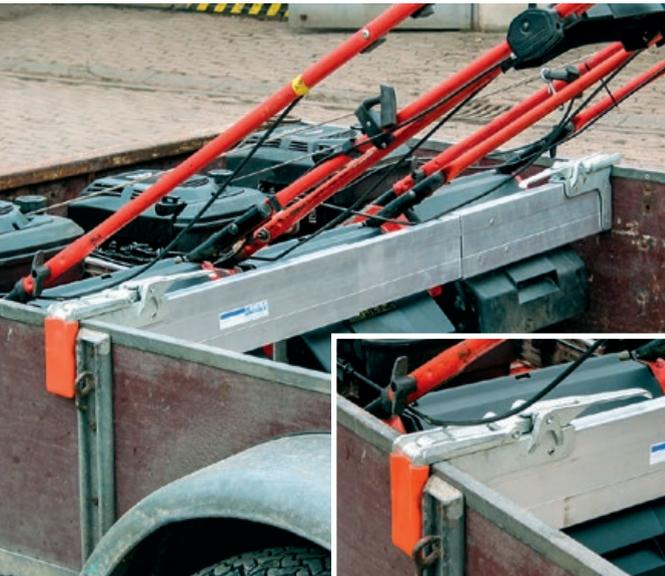
◀ Formschlüssige Sicherung von handgeführten Rasenmähern durch Klemmbalken mit Hakensicherung
