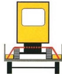
**Achtung:** Bei Sicherung von selbstfahrenden Arbeitsmaschinen ist die Feststellbremse zu betätigen und ein ggf. vorhandenes Drehwerk festzustellen. Die gezeigte Sicherungsmethode durch sog. „Kopflashing“ ist nicht uneingeschränkt anwendbar, da maschinenspezifisch die mögliche Kippempfindlichkeit zur Seite zu berücksichtigen ist!
