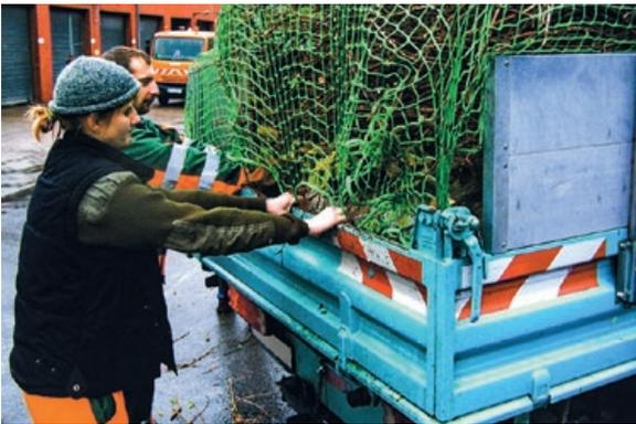
Bei losen Lasten Netze und Planen nutzen.
