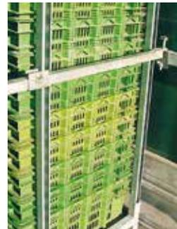
*Ladungssicherung durch formschlüssig wirkende Spannelemente*
