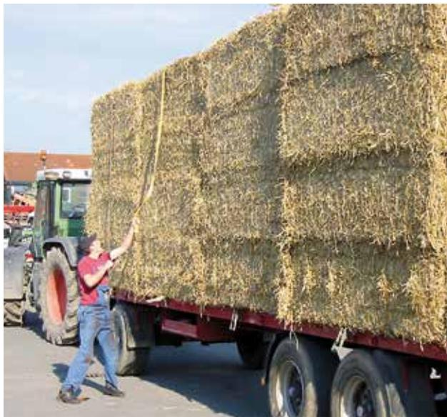
*Kraftschlüssige Ladungssicherung durch Niederzurren*
