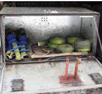
Das Mitführen von Zurrmitteln in Transportbehältern wirkt einem zusätzlichen Verschleiß entgegen
