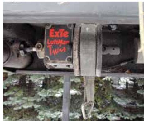
*Automatisches Nachspannen der Zurrgurte durch Luftdruck spart das Nachzurren*
