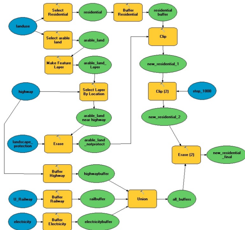
Abb.: Beispiel einer GIS-basierten Analyse mit dem "Model Builder" in ArcGIS (blau: Ausgangsdaten; gelb: GIS-Operationen; grün: Zwischenergebnisse und Endergebnis)
