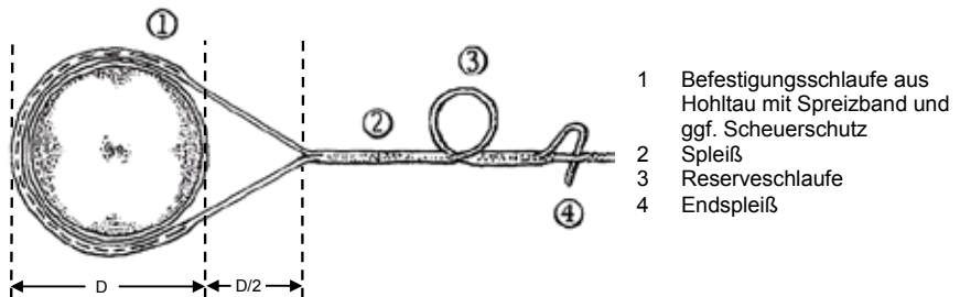
Abb. 9: Verbindung mit Hohltau
